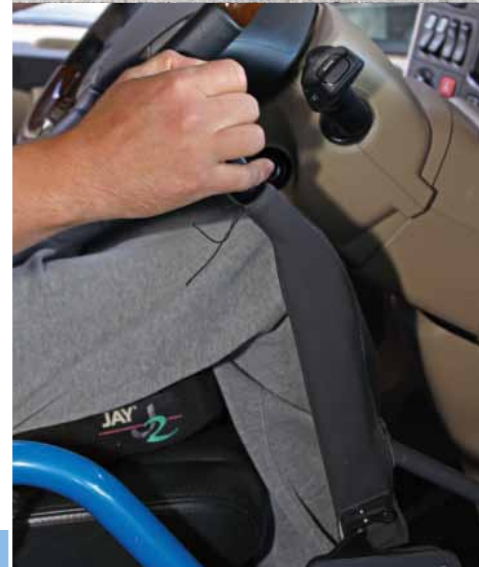
Bremse und Gas: ein Hebel für alles
